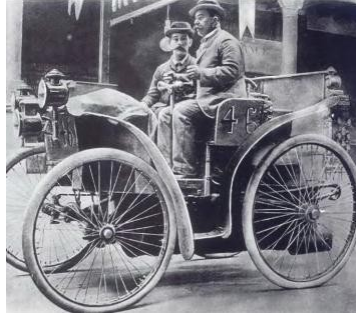
Рисунок 10. Автомобиль «Молния» демонстрирует миру съемные покрышки Michelin
