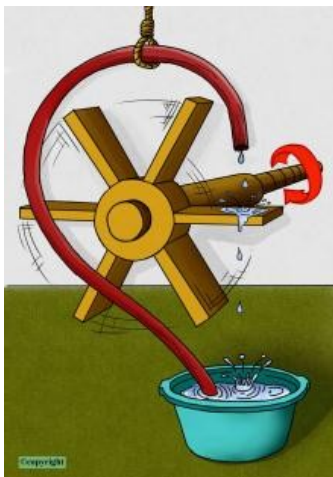
3-сүрөт. “Түбөлүктүү кыймылдаткычтын” бир варианты
