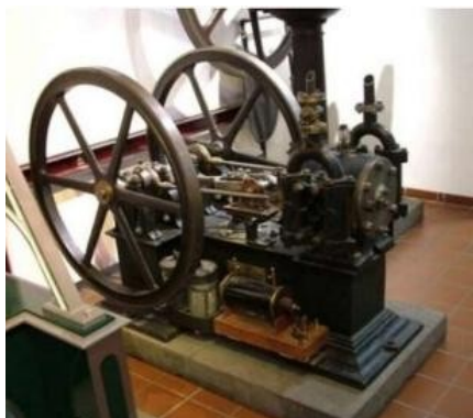
2-сүрөт. Филипп Лебондун газ кыймылдаткычы
