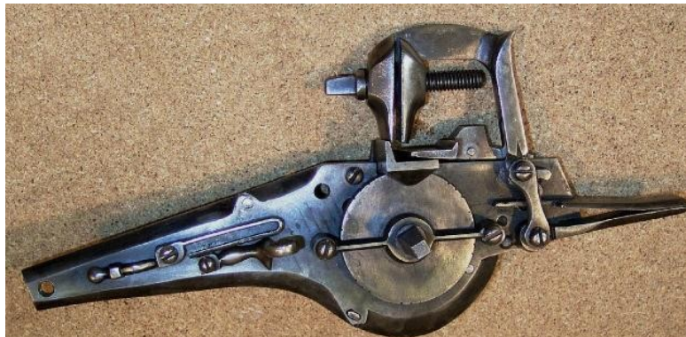
13-сүрөт. Леонардо да Винчинин дөңгөлөктүн кулпусу ойлоп табуусу
